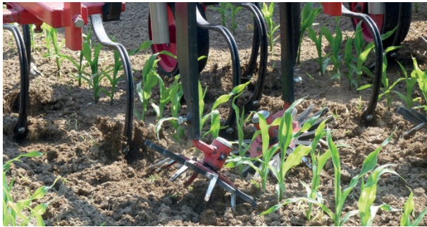
Vingerwieders pakken kleine en pas ontkiemde onkruiden in de gewasrij aan. De 'vingers' zijn flexibel en beschadigen het gewas niet.
